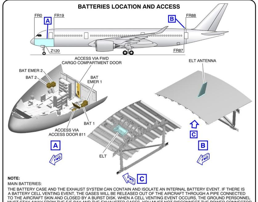
MUST STAY AWAY FROM THE E/E BAY AND THE EXHAUSTED GASES. YOU MUST NOT DISCONNECT THE POWER CONNECTOR OR CUT OFF THE BATTERY POWER WIRES TO DISCONNECT THE BATTERIES FROM THE ELECTRICAL NETWORK.
